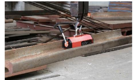
\*Poids maximum pour pièces en acier S235JR avec surfaces en contact lisses et de taille et épaisseur suffisante. La capacité de levage varie en fonction du type de matière, de l'épaisseur de la pièce, de la taille et de la qualité de la surface en contact.
